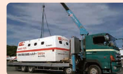
小型クレーン付4t車で運搬・設置が可能
