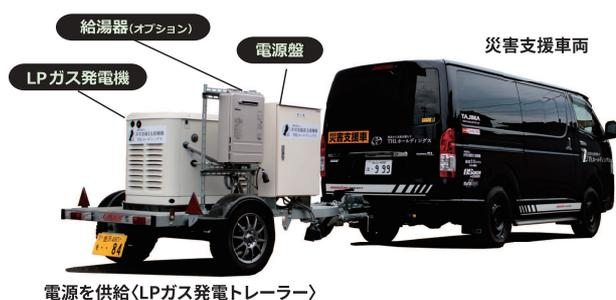
電源を供給(LPガス発電トレーラー)
